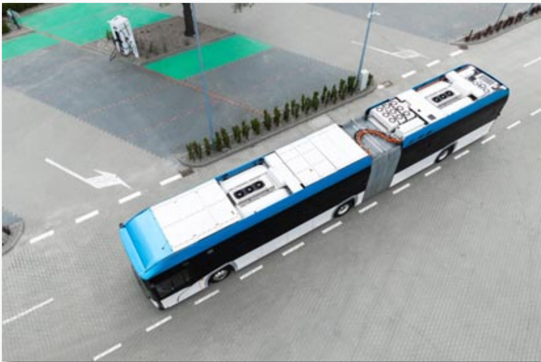
Den 18-meter lange Solaris-bus set fra oven. Det er kun køleaggregater til teknikken, der er synlige.
