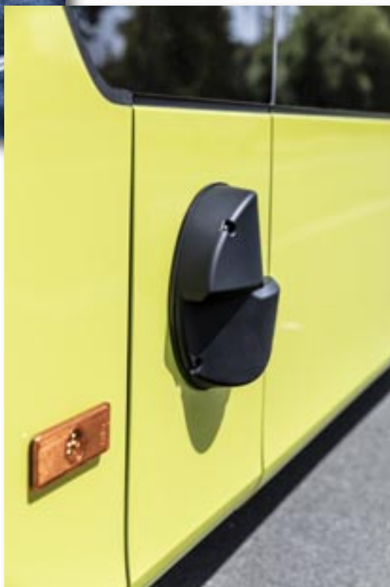
Der er en stor sikkerhedspakke i bussen - her er det radaren på siden, som "kigger" for- og agterud.
