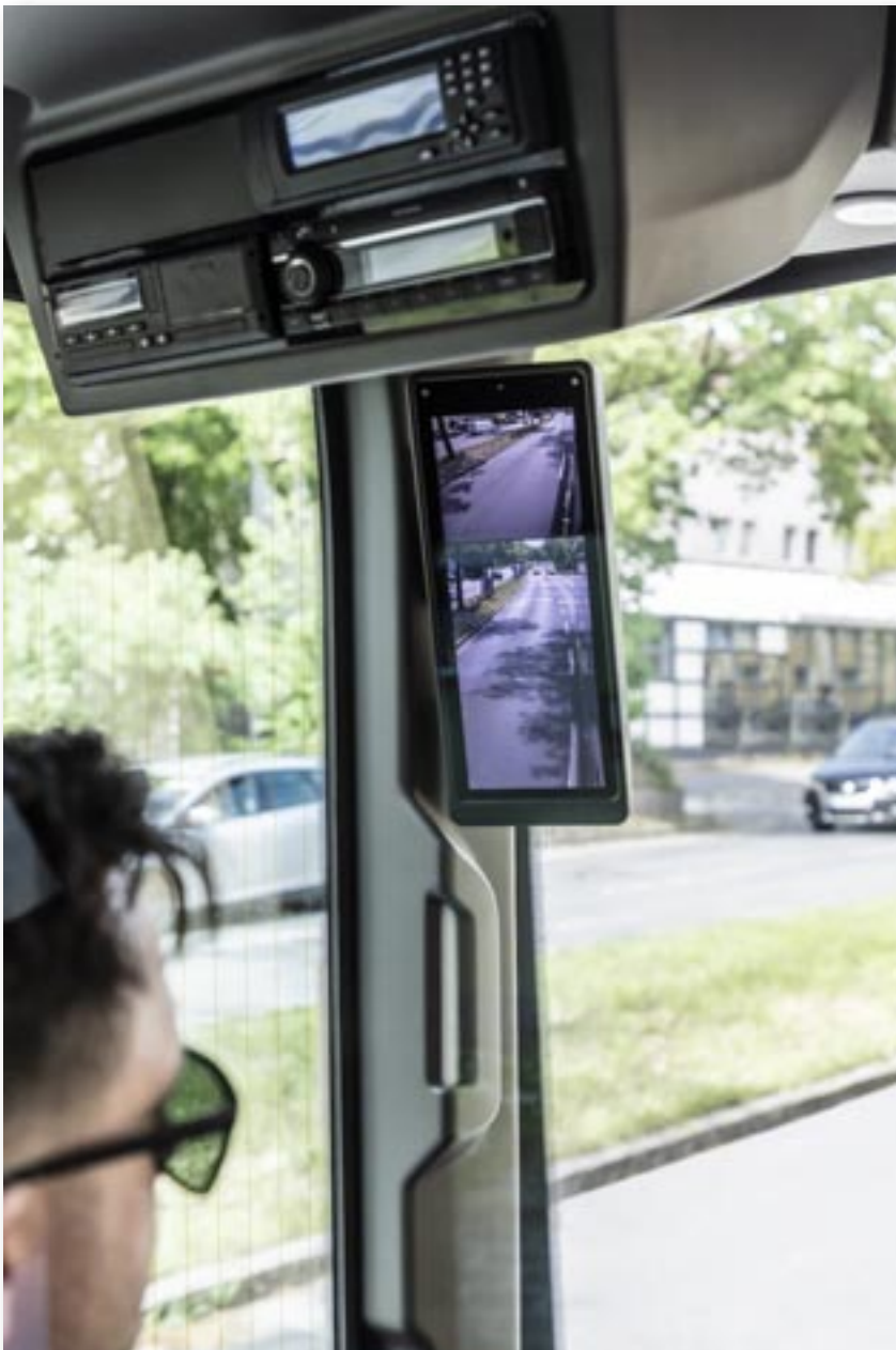
Gode og overskueligt placerede mirrorcam'er med alarmer i A-stolpen.
