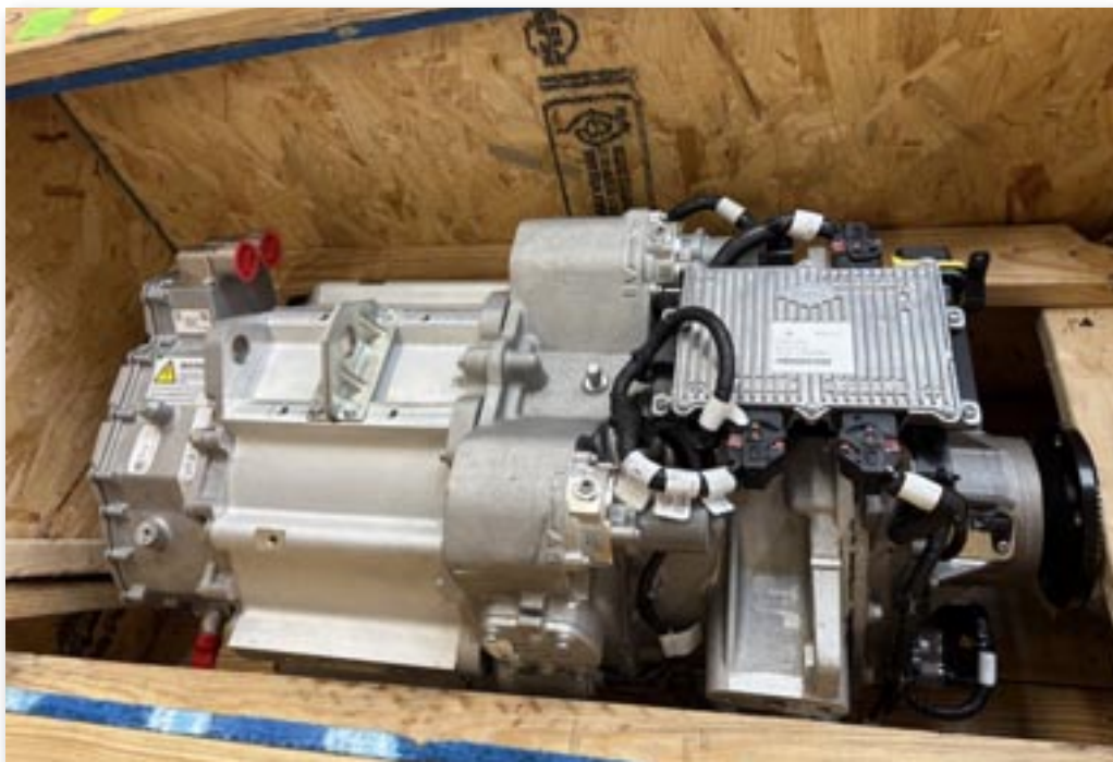
En tre-trins gearkasse fra Dana. Det lyder dansk, men er amerikansk og lavet i Kina.
