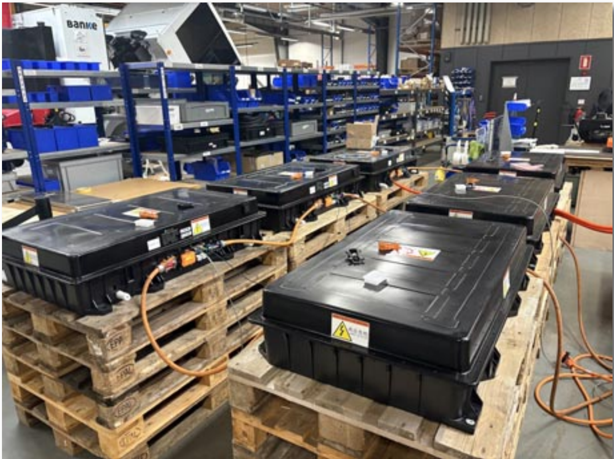
Batterier under forsøg - også her er "prøvebænken" paller, hvilket gør det nemt at flytte rundt de tunge sager.
