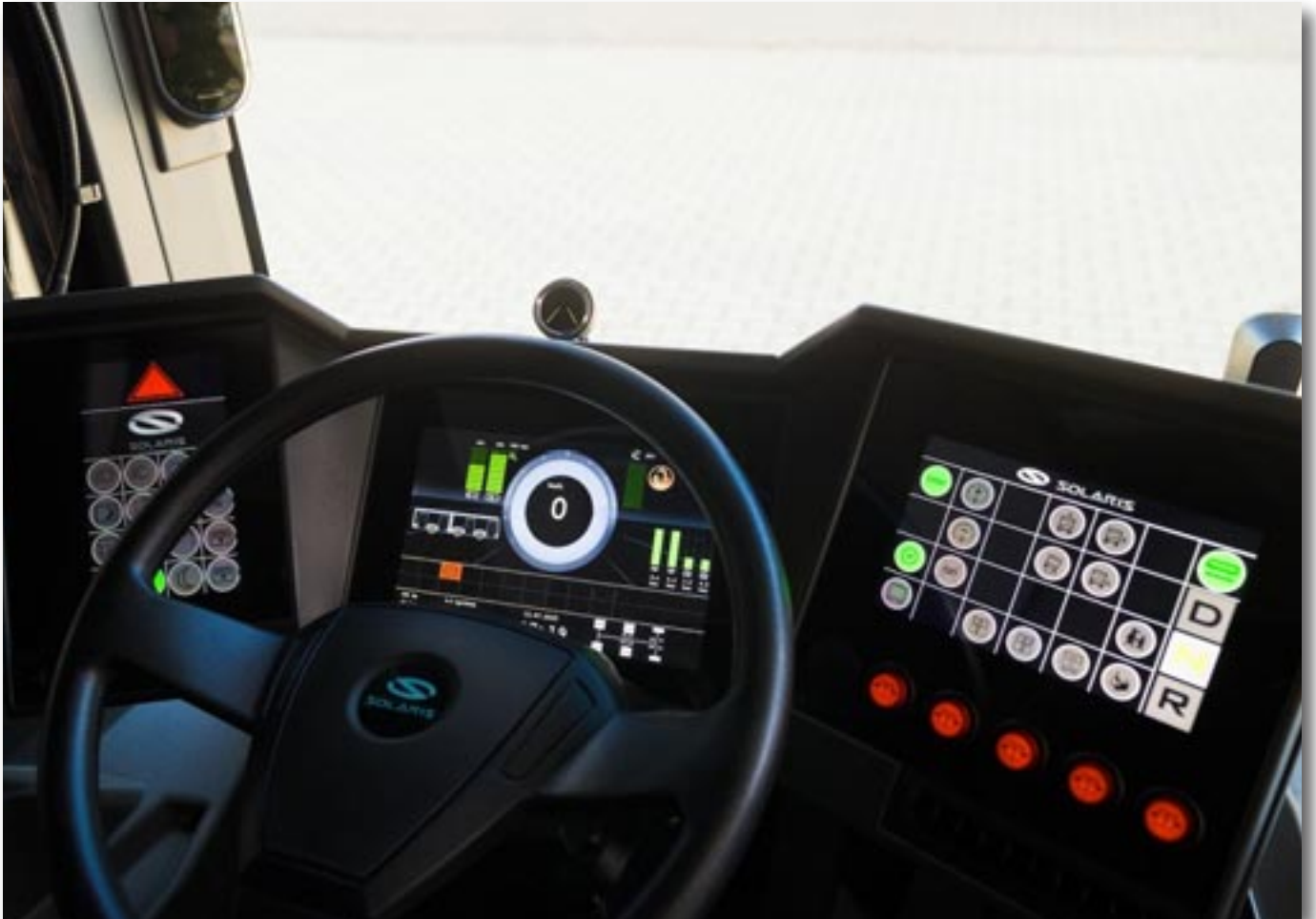
Instrumentbordet i den brintelektriske ledbus. Digitale tuch-knapper.
