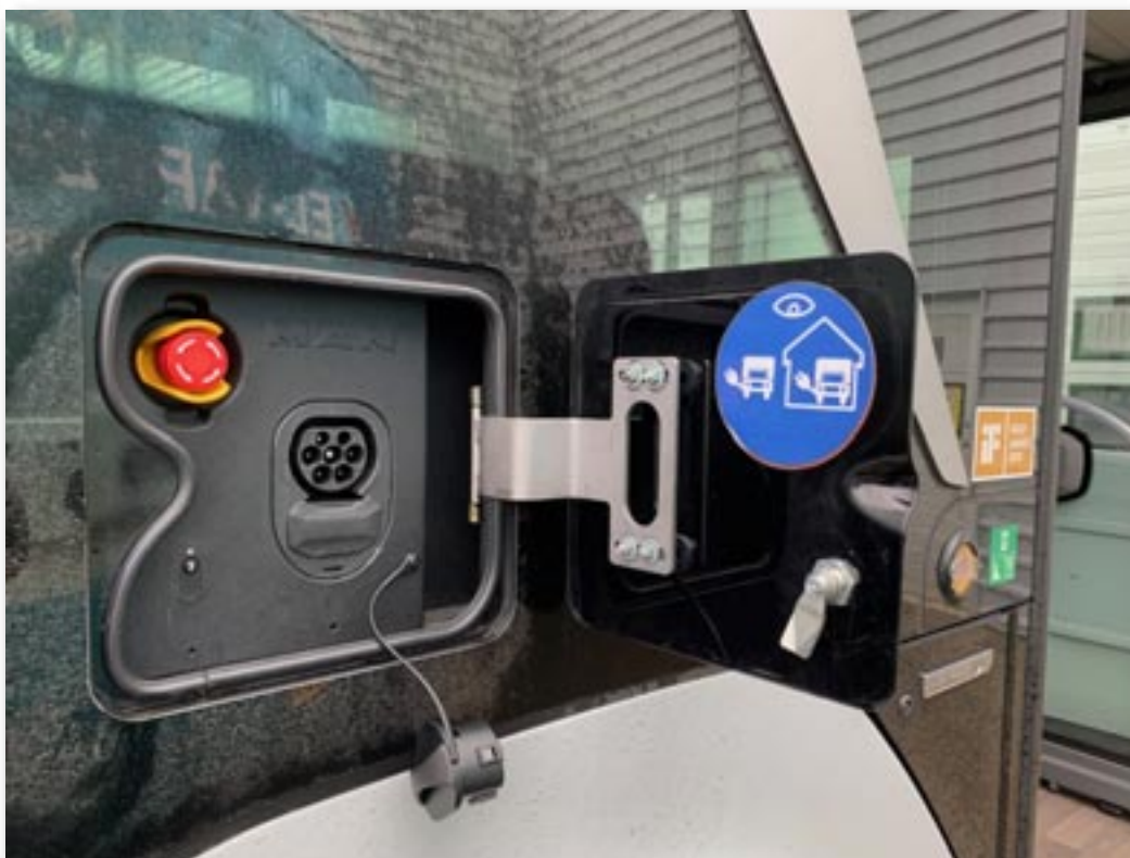
Tankdækslet dækker over en kabeltilslutning - og et nød-stop, hvis det skulle blive for spænende.
