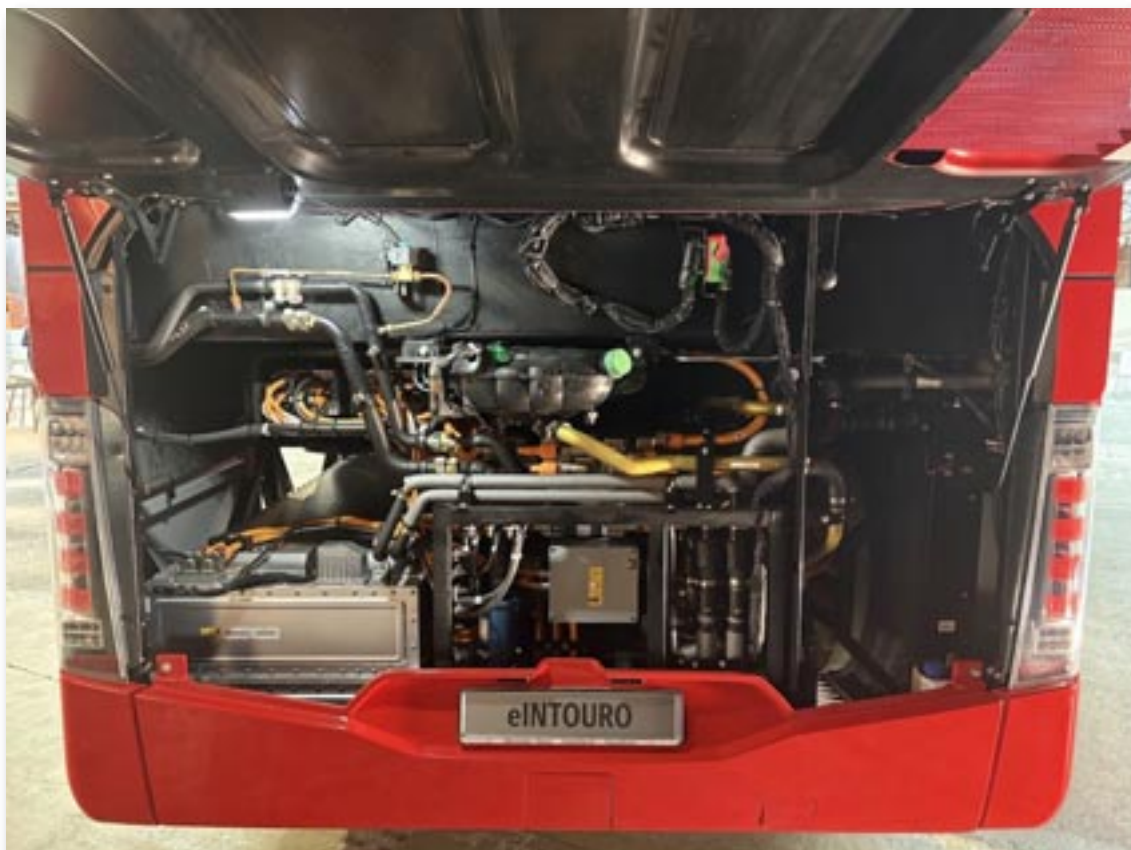
El-motoren er placeret samme sted, som motoren i en diesel-Intouro.
