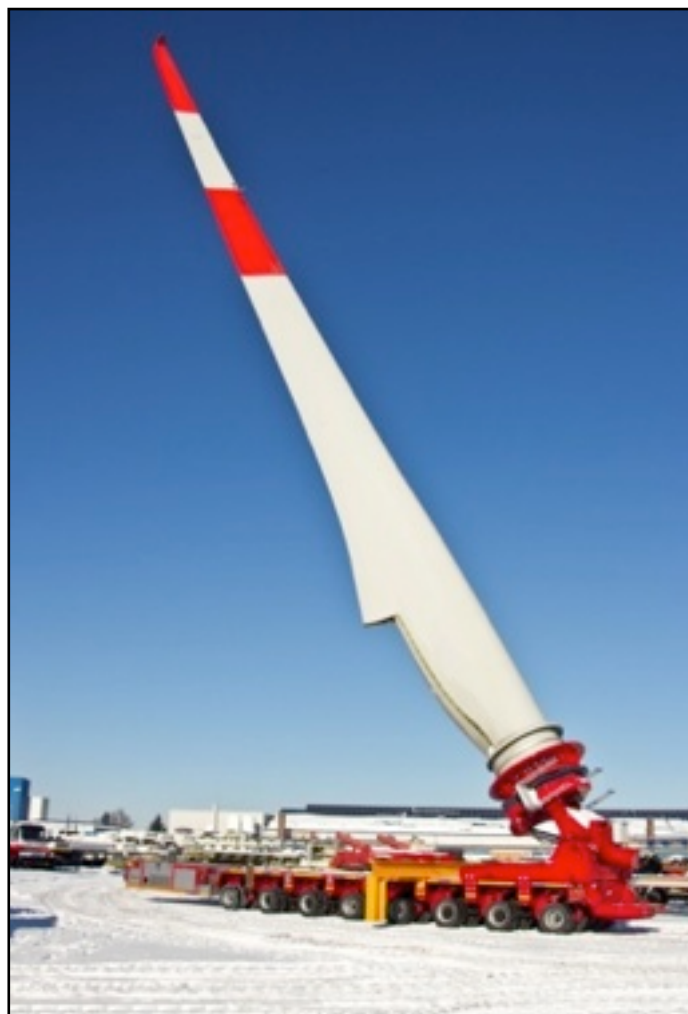
På Bauma 2013 udstillede Goldhofer bl.a. FTV 300, der er specialdesignet til transport af vindmøllevinger. Foto: Goldhofer.
