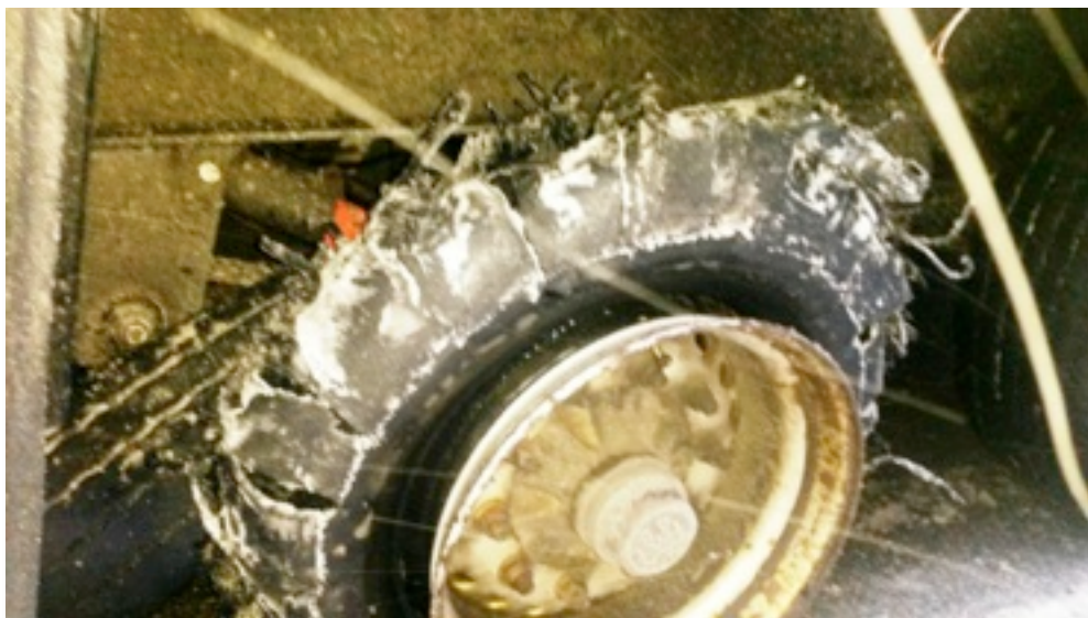
Punkteret dæk på påhængskøretøj, der transporterede farligt gods. (Foto: Statens vegvesen.)
